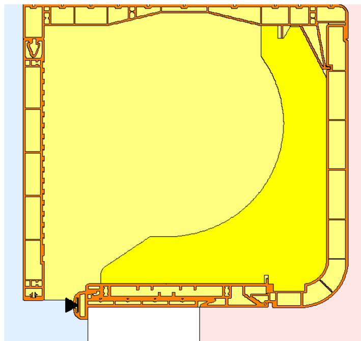
2 Simulationsmodell Wärmedurchgangskoeffizient
