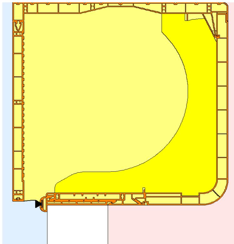
2 Simulationsmodell Wärmedurchgangskoeffizient
